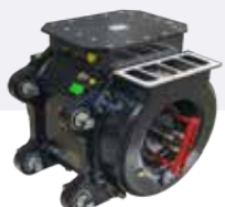
Traktionsmotor Stadler KISS für Caltrain
