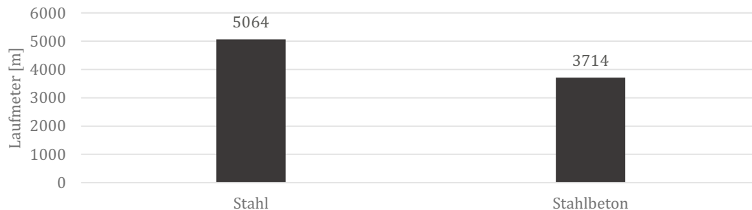
Abbildung 4.18: Summierte Laufmeter der Fassadenunterkonstruktion nach Material
