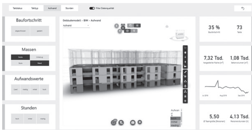
Abbildung 4: Beispielhafte Darstellung des Betonmonitoring-Dashboards
