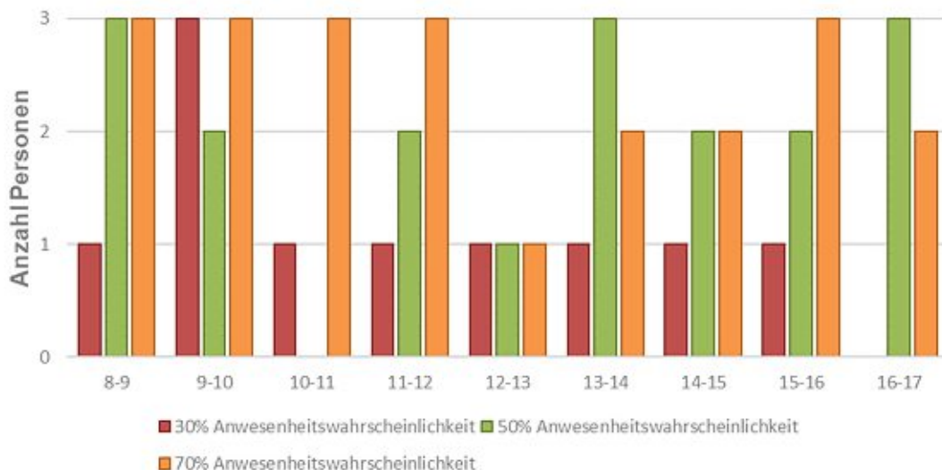
Abbildung 33: Anzahl der Personen je Stunde in Abhängigkeit der Anwesenheitswahrscheinlichkeit in einem Dreipersonenbüro an einem Arbeitstag (Leeb, Deseyve, Höfer, Korjenic, & Bednar, 2011, p. 1214)
