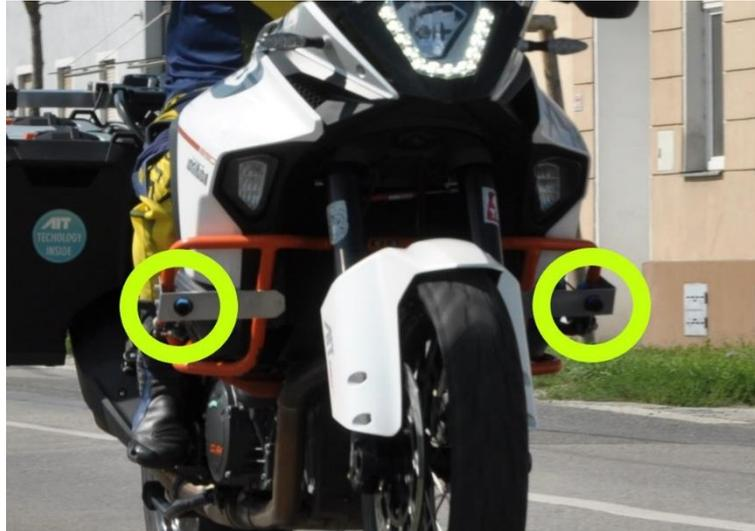
Abbildung 6: Positionierung der Kameras
