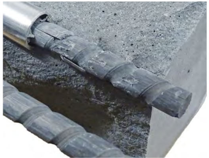
Bild 15 Abgeschnittene Stabwendel eines Stabs der Variante d) Sheared off helical rib of a rod of variant d)
